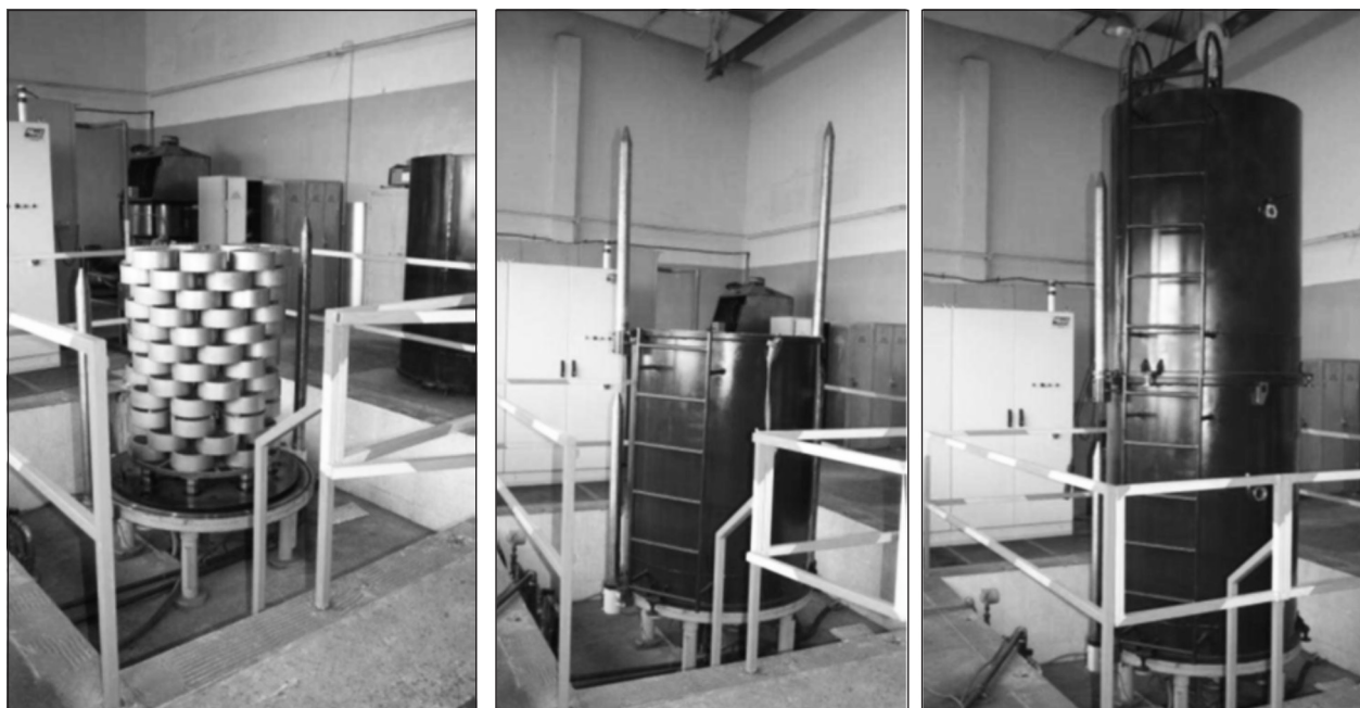
Комплекс с изменяемой геометрией рабочей камеры (высота загрузки - 1,4 или 3,0 м)
