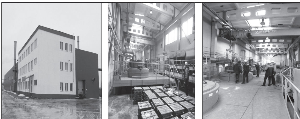
Реализован полный технологический цикл пиromеталлургического производства свинца из аккумуляторного лома. 10 000 т свинца в год
