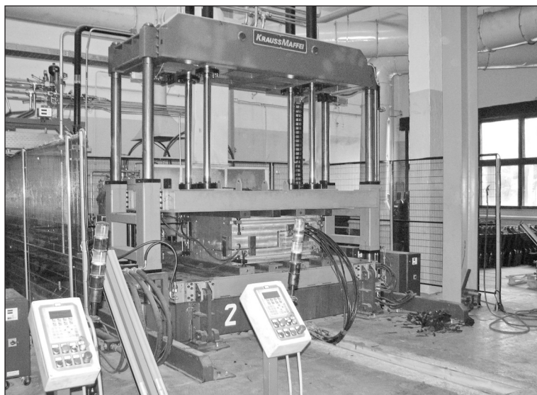
Рис. 5. Пресс для формовки деталей из пластмассы Телен
