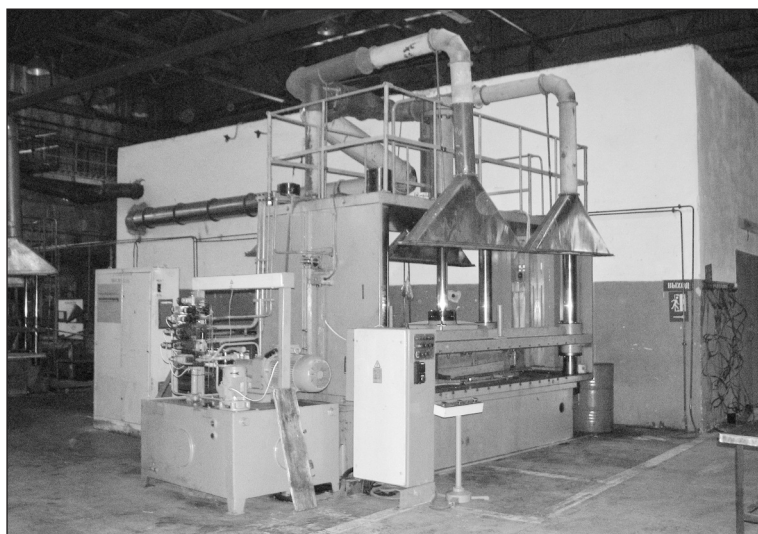
Рис. 6. Пресс для изготовления трехслойных обивок
