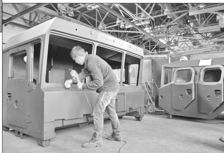
Рис. 9. Контролер ОТК производит приемку готовой кабины
