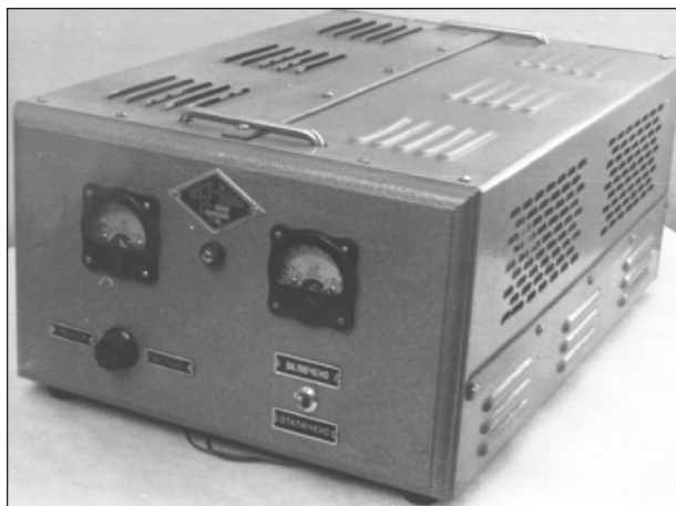
Рис. 2. Блок автоматического регулирования напряжения (АРН) конструкции МТЗ
