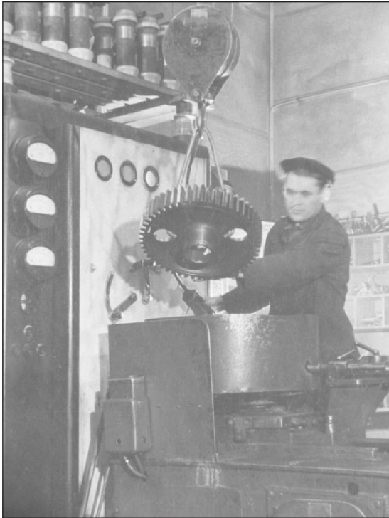
Рис. 4. Общий вид установки для поверхностной закалки бортовых шестерен трактора МТЗ
