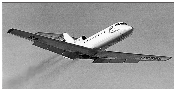
Рис. 4. Як-40 на взлёте. Виден дымный след за двигателями
