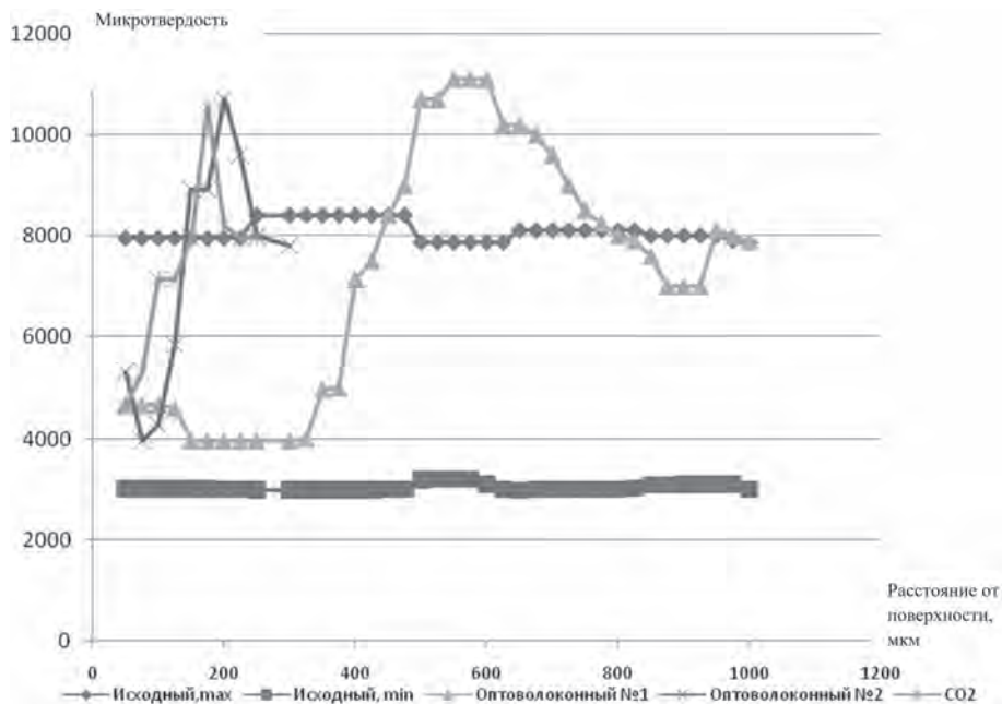
Рис. 8. Анализ микротвердости исходного образца и образцов после лазерного упрочнения
