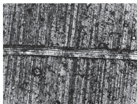
Рис. 4. Характер следа от царапания иглой поверхности стального образца, покрытого подслоем титана толщиной 3 мкм и слоем TiN толщиной 3 мкм, обработанным импульсным магнитным полем. \times 300
