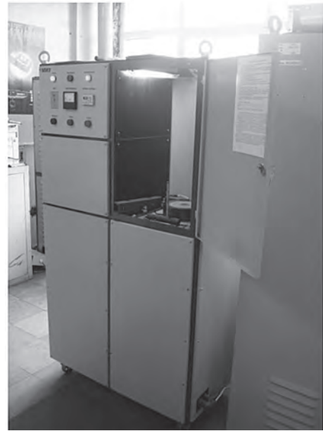
Рис. 6. Магнитно-импульсная установка для упрочнения стальных изделий
