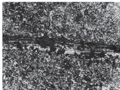
Рис. 2. След от иглы на поверхности стального образца с нанесенным покрытием, обработанным магнитно-импульсным воздействием, после исследования прочности сцепления покрытия с подложкой. \times 300
