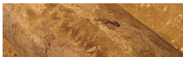
Рис. 11. Отслоившаяся окалина на поверхности горячекатаных заготовок диаметром 140 мм
