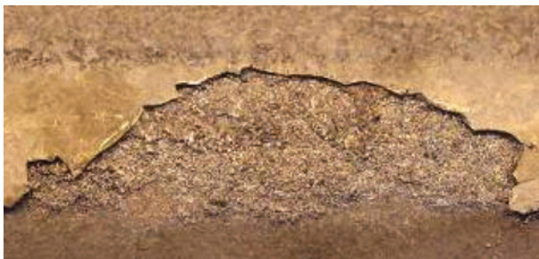
Рис. 6. Внешний вид поверхности заготовки с металлическим блеском под отслоившейся окалиной
