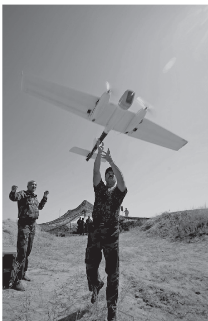
Рис. 14. Действующий макет беспилотного авиационного комплекса видеомониторинга местности и объектов
