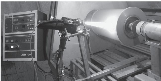
В 2010 г. для ОАО «Щучинский завод автопровод» разработана технология восстановления изношенной поверхности барабана отжига медной проволоки МСС 80/8/21, высокоскоростным газопламенным напылением керамического покрытия шнурами производства ТЦ «СП ТЕХНИКОРД» (Россия), аппаратом ТЕНА-Уэ. В соответствии с требованиями чертежа толщина напыленного и обработанного шлифованием слоя покрытия должна быть не менее 0,3–0,5 мм. Размеры барабана:  $d = 200$  мм,  $L = 300$  мм.
