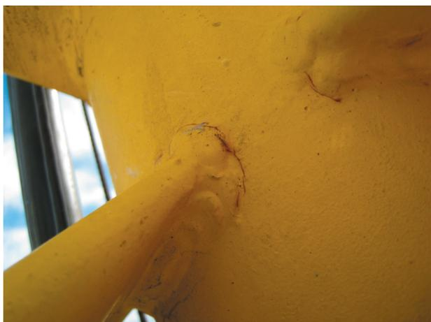
Рис.2. Зарождение усталостных трещин
