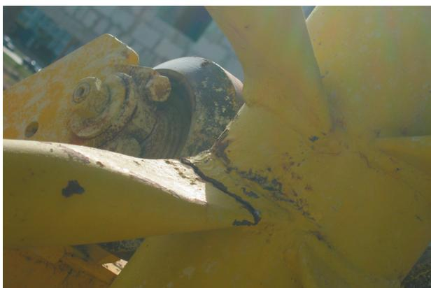
Рис.3. Развитие усталостной трещины, предшествующее разрушению сварного соединения
