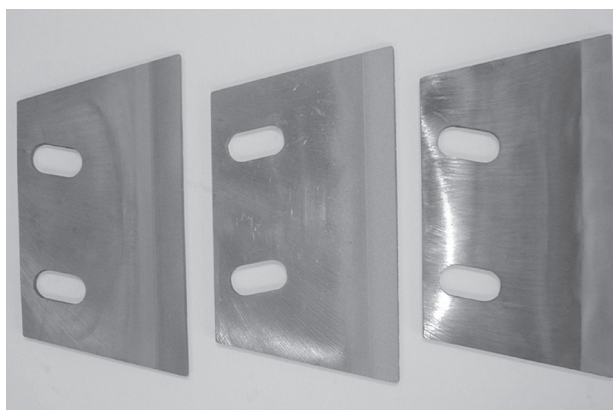
Рис. 10. Ножи кормоуборочного комбайна: а — отдробеструенный; б — напыленный; в — оплавленный
