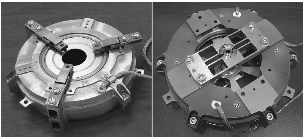
Рис. 3. Оборудование для проведения испытаний материалов на трение и износ: а — бортовой трибометр; б — модуль подшипников скольжения
