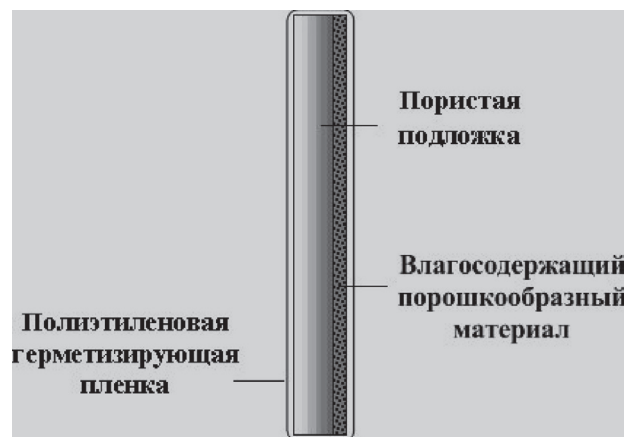
Рис. 7. Гибкий многослойный влагосодержащий экран
