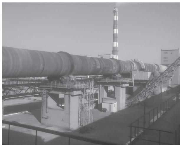
Рис. 3. Общий вид вращающейся печи для обжига
