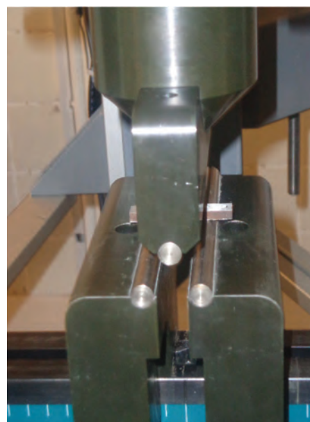
Рис. 6. Испытываемый образец под плавно нарастающей нагрузкой
