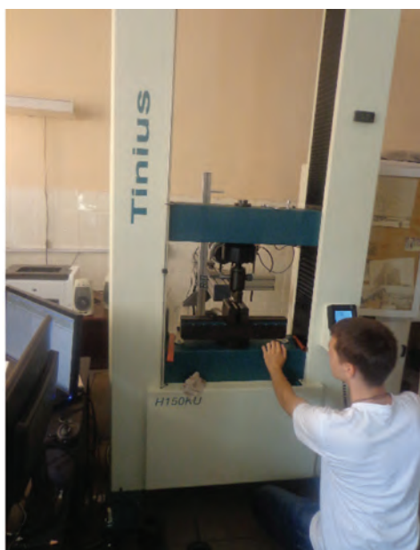
Рис. 5. Универсальная испытательная машина H 150KU
