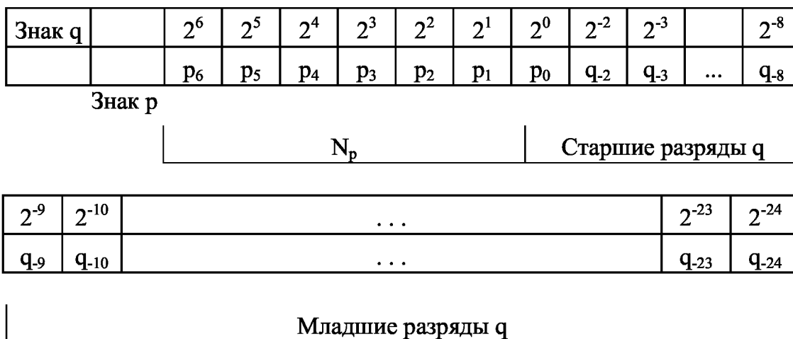
Рис. 2.2. Разрядная сетка микроЭВМ типа DEC с плавающей запятой в формате слова
