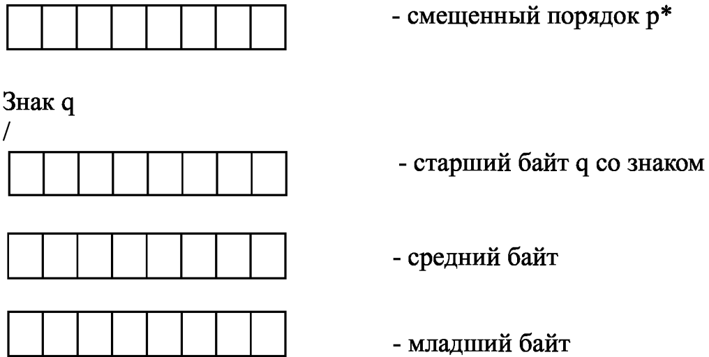
Рис. 3.2. Структура 4 байтов при вводе/выводе
