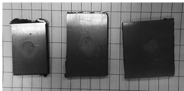
Рисунок 4 — Взаимодействие обычной стали с раствором медного купороса
