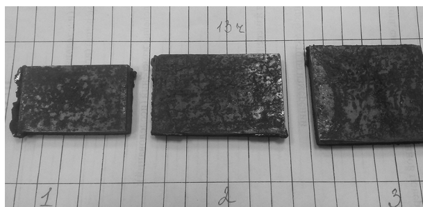
Рисунок 2 — Обычная сталь после 13 ч испытаний в растворе хлористого натрия / воздух
