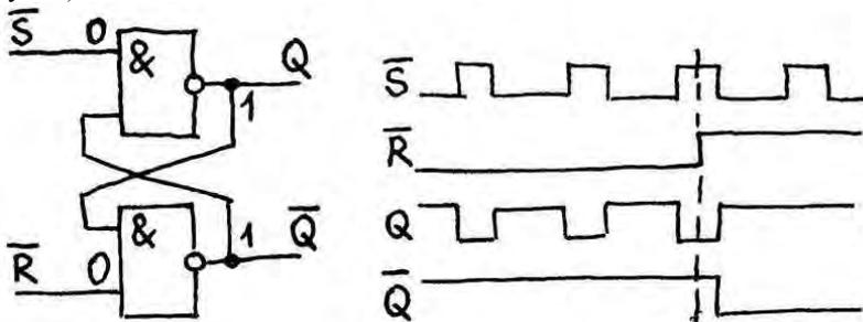
На основе такого синхронного выключателя можно строить синхронные коммутаторы [1], синхронные формирователи импульсов по переднему [2], по переднему и заднему фронтам [3] входного сигнала, синхронные старт-стопные генераторы [4].
