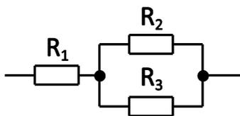
Рис. 3 – Схема со смешанным соединением элементов соединением
