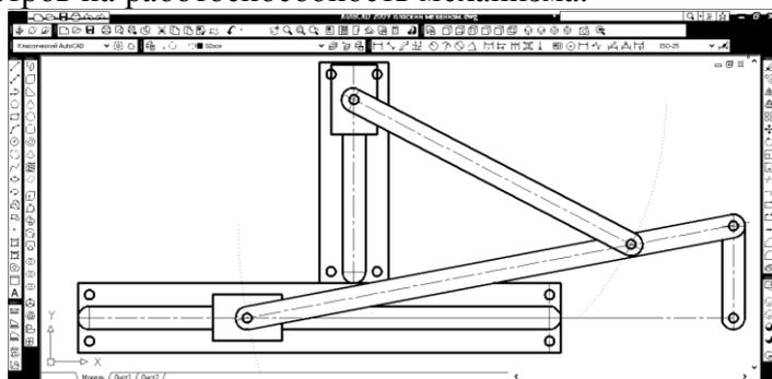
Рисунок 2 – Модель шарнирно-рычажного механизма в среде AutoCAD
