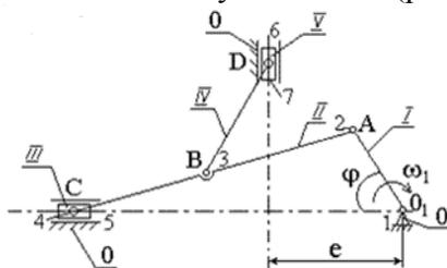
Рисунок 1 – Кинематическая схема механизма
