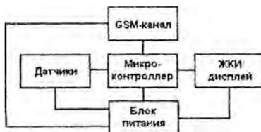
Рисунок 1 – Структурная схема системы контроля метеорологических
