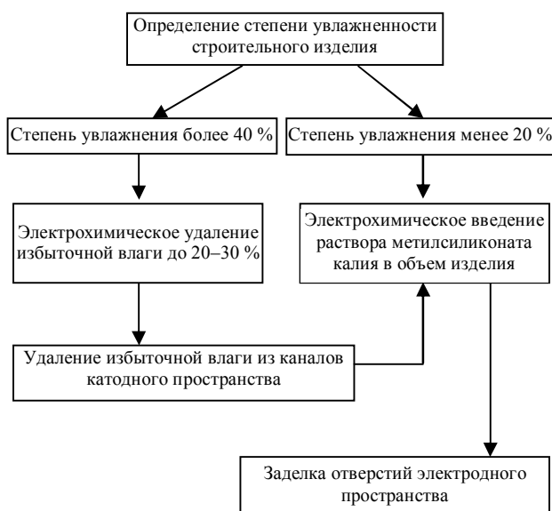
Рис. 2. Принципиальная технологическая схема комбинированного способа гидрофобной защиты строительного изделия
