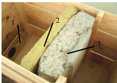
Рис. 2. 1 – звуковые колонки; 2 – минераловатная плита; 3 – бетонная стеновая панель
