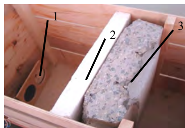
Рис. 3. 1 – звуковые колонки; 2 – плита пенополистирольная; 3 – бетонная стеновая панель
