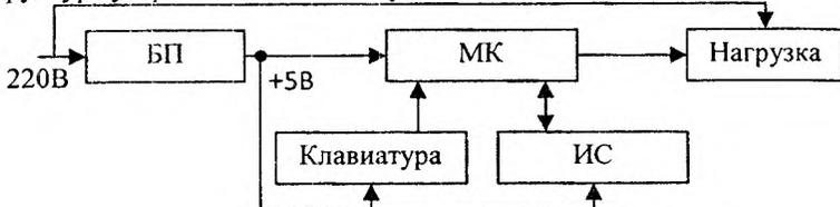
Где блок питания (БП) преобразует входное переменное напряжение 220 В в постоянное стабилизированное 5 В, клавиатура позволяет организовывать внешнее управление работой системы, интерфейс связи (ИС) организует связь с вычислительной системой при необходимости настройки, проверки, а также модернизации (на программном уровне) работящего устройства. Микроконтроллер организует работу всех частей системы. В качестве нагрузки выступает лампа накаливания.
