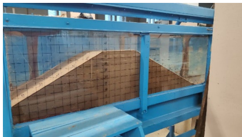
Рисунок 1 – Лоток с размещённой моделью плотины
