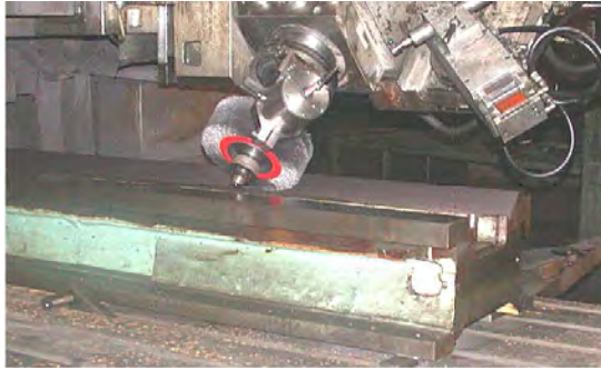
Рис. 3. Формирование плакирующего слоя на рабочей поверхности треугольных направляющих скольжения станины
