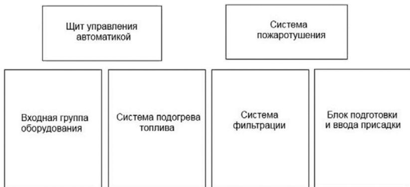
Рисунок 2 – Блок-схема оборудования для ввода и смешивания
