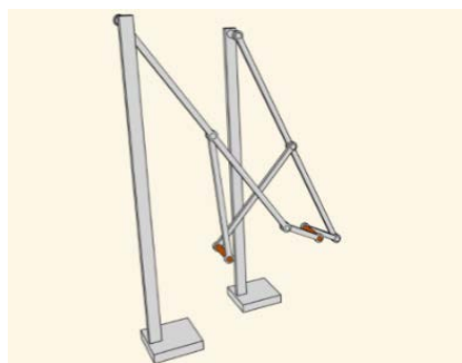
Рисунок 2 – Лямбда-механизм с «ногой»
