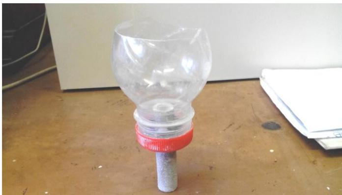
Рисунок 2 – Оснастка для нанесения промежуточного слоя
