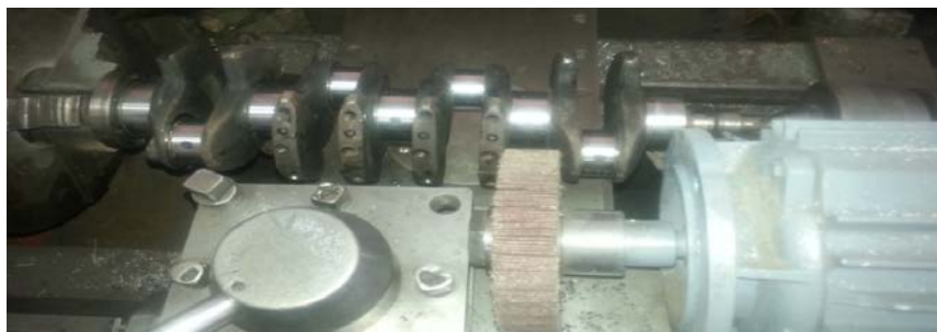
Рисунок 1 – Эксцентричное вращение щетки и ее частей в притирки поверхности коленчатых валов ДВС
