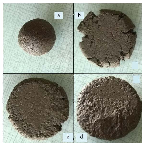
Рис. 4. Оценка консистенции смеси: а – шарик диаметром 25 мм; б, с – примеры недостаточной пластичности смеси; d – пример смеси, консистенция которой соответствует консистенции мягкого пластилина
