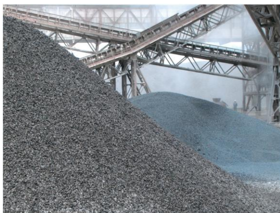
Рис. 3.7. Щебень после обработки водным раствором сульфата алюминия
