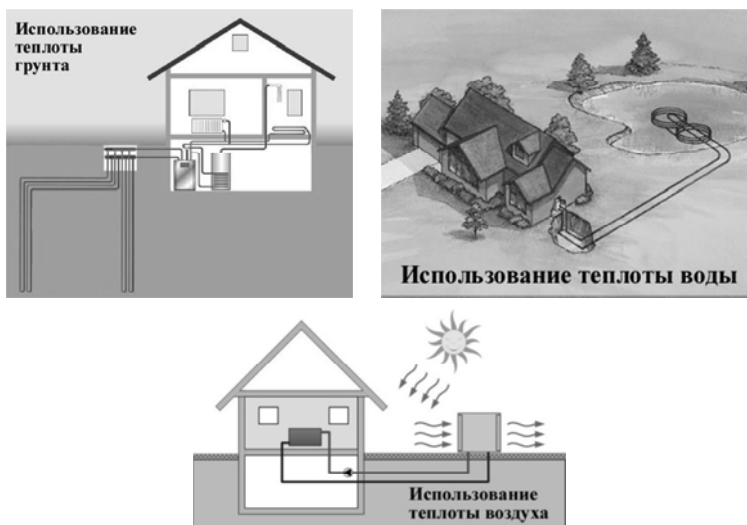
Рис. 8.1. Источники низкопотенциальной теплоты (грунт, вода, воздух)
