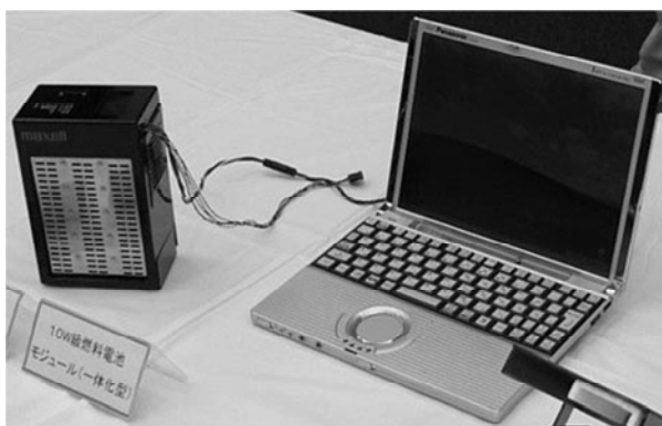
Рис. 11.3. Топливный элемент для питания персонального компьютера
