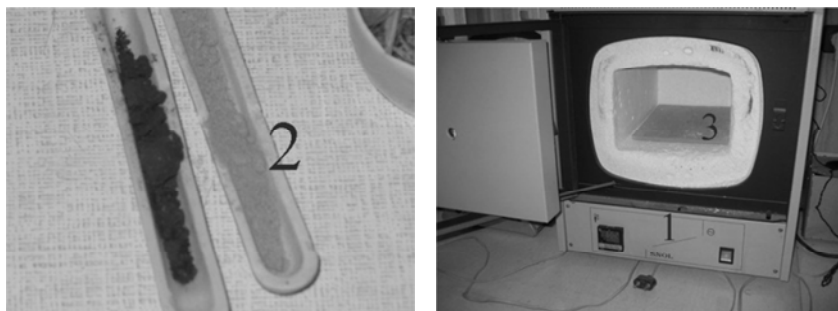
Рис. 7.1 Внешний вид экспериментальной установки: 1 – муфельная печь; 2 – лодочки; 3 – пластинка керамическая
