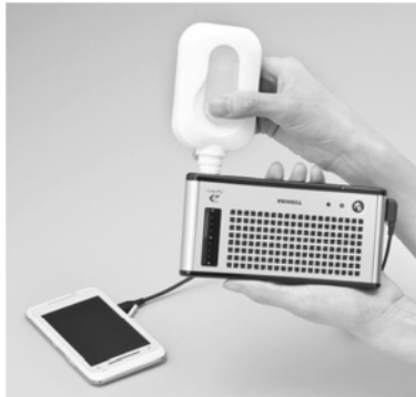
Рис. 11.5. Зарядное устройство компании Toshiba на топливном элементе
