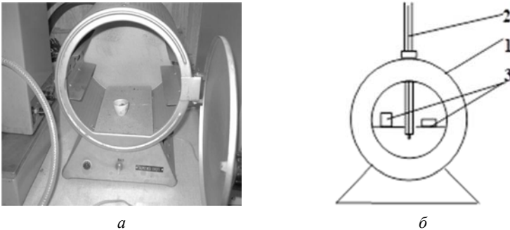
Рис. 6.4. Фотография (а) и схема (б) экспериментальной установки: 1 — сушильный шкаф; 2 — термометр; 3 — бюксы
