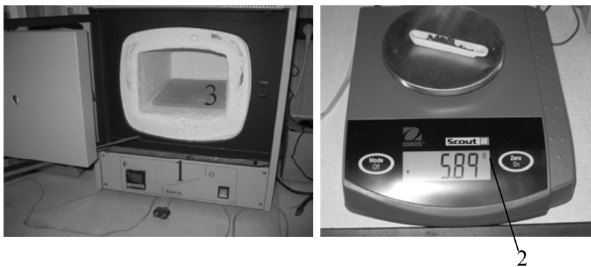
Рис. 8.4. Муфельная печь и весы: 1 – муфельная печь; 2 – лодочки; 3 – пластинка керамическая
