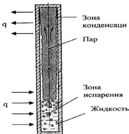
Рис. 4.3. Принцип действия термосифона
