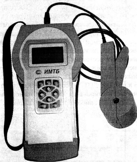
Рис. 8. Прибор ИМТБ для бесконтактного измерения токов утечки в высоковольтном оборудовании
