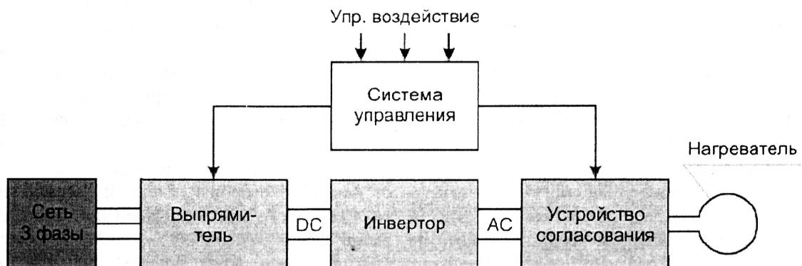
Рис. 1 — Блок-схема полупроводникового источника питания для индукционного нагрева
