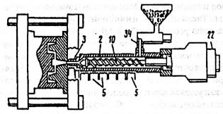
рез загрузочное устройство 34 и при вращении винта 10 движется в направлении к форме. Усилия, связанные с дальнейшим измельчением шихты, трения ее о стенки желоба 2 и поверхностью винта приводят к нагреву шихты. Дополнительный внешний нагрев от горелок 5 приводит к размягче-
