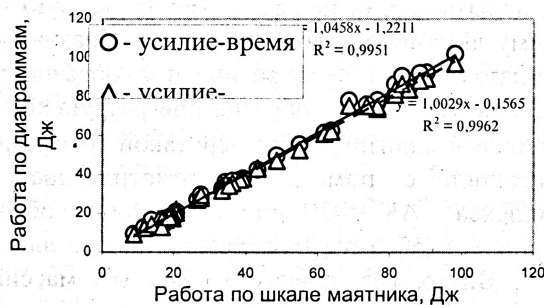
Рис.3. Полная работа разрушения по шкале маятника и по диаграммам «усилие-время» и «усилие-прогиб»
