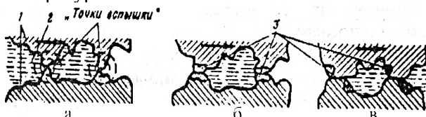
Рис. 19. Схема полирующего действия смазочного материала: а – возникновение "точек вспышки"; б – образование продуктов взаимодействия активных элементов смазочного материала с металлом; в – пластичный сдвиг продуктов взаимодействия (полирование): 1 – трущиеся детали; 2 – смазочный материал; 3 – продукты взаимодействия.
