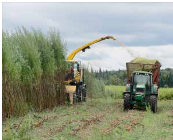
Рис. 2. Уборка коммерческих плантаций ивы комбайном Case New Holland со сменным хедером 130 FB
