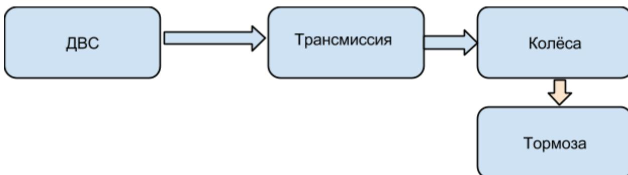
Рисунок 1 – Схема движения энергии в автомобиле с механической трансмиссией
