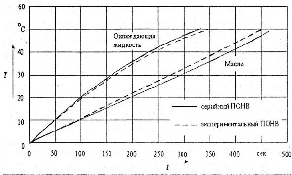
Рис. 4. Графики прогрева охлаждающей жидкости и масла
