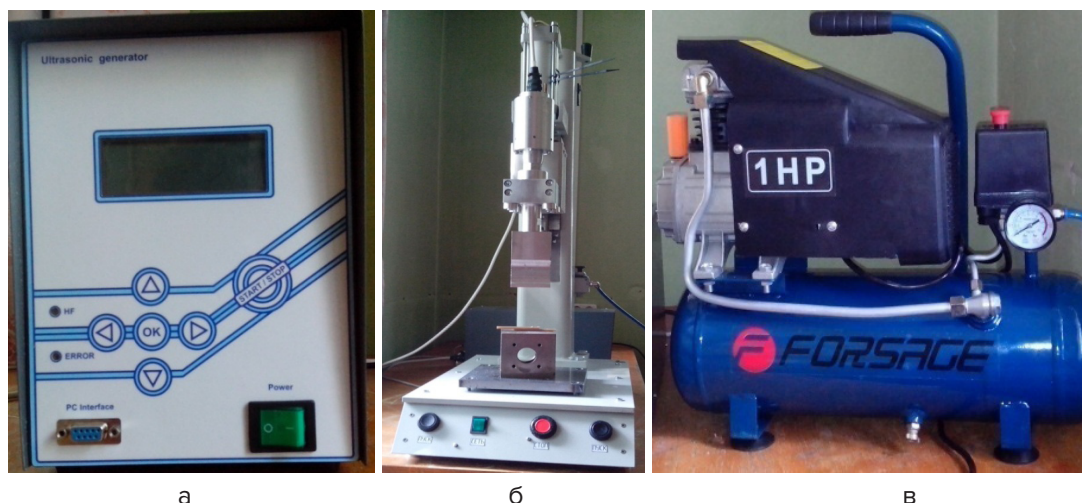
Рис. 1. Экспериментальная установка для ультразвуковой сварки полимеров: а — генератор ультразвуковых колебаний; б — пневматический пресс с пьезокерамическим преобразователем и пуансоном-волноводом; в — компрессор
