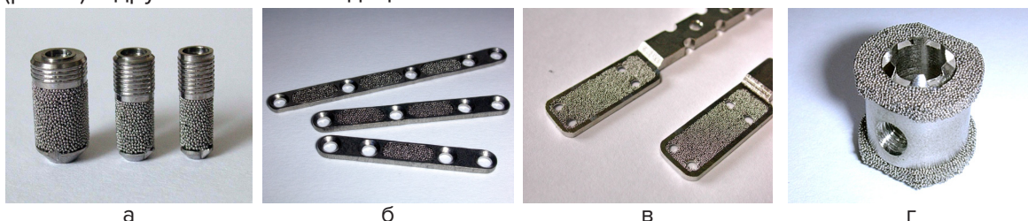
Рис. 8. Изделия медицинского назначения из компактно-пористого титана: дентальные имплантаты (а), пластины для остеосинтеза (б), эндопротезы нижней челюсти (в), и имплантаты для межтелового спондилодеза позвоночника (г)
