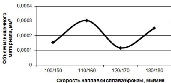
Рис. 9. Зависимость объема изношенного материала от скорости наплавки двухслойного мультимодального покрытия в условиях сухого трения
