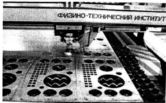
Рис. 6. Фрагмент приборной панели, вырезаемой с помощью лазерного технологического комплекса «ТЛ-1,5-Салар»
