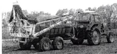
Рис. 4. Машина для внесения жидких минеральных удобрений АПЖ-12 в транспортном положении
