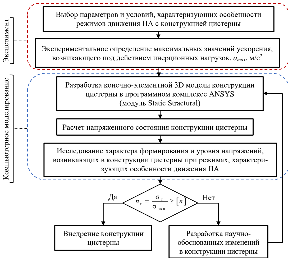
Рисунок 1. – Блок-схема методики моделирования напряженного состояния конструкций цистерн прямоугольного сечения ПА
