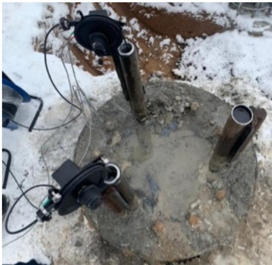
Рисунок 4. Оголовок сваи 2оп с выпуском труб доступа
