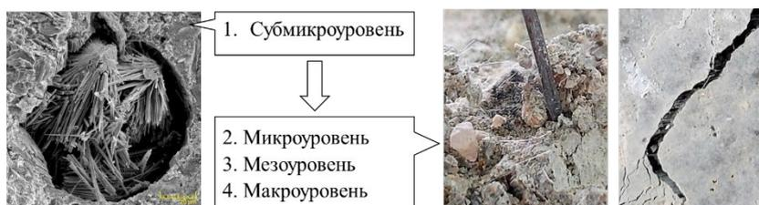
Рисунок 3. Уровни строения структуры напрягающего фибробетона
