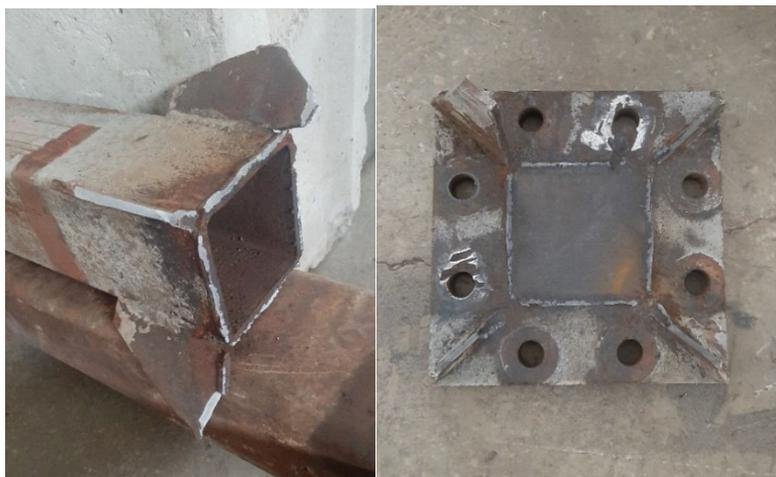
Рисунок 6. Разрушение по сварному шву по фланцу монтажного узла нижнего пояса стропильной ферм
