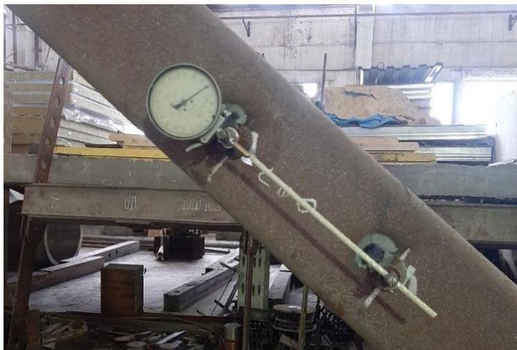
Рисунок 4. Контроль напряжений в элементах ферм с помощью многооборотных индикаторов 1МИГ с ценой деления 0,001 мм на базе 200 мм
