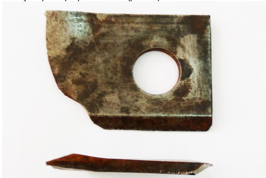
Рис. 13. Разрушившийся нож фирмы Claas
